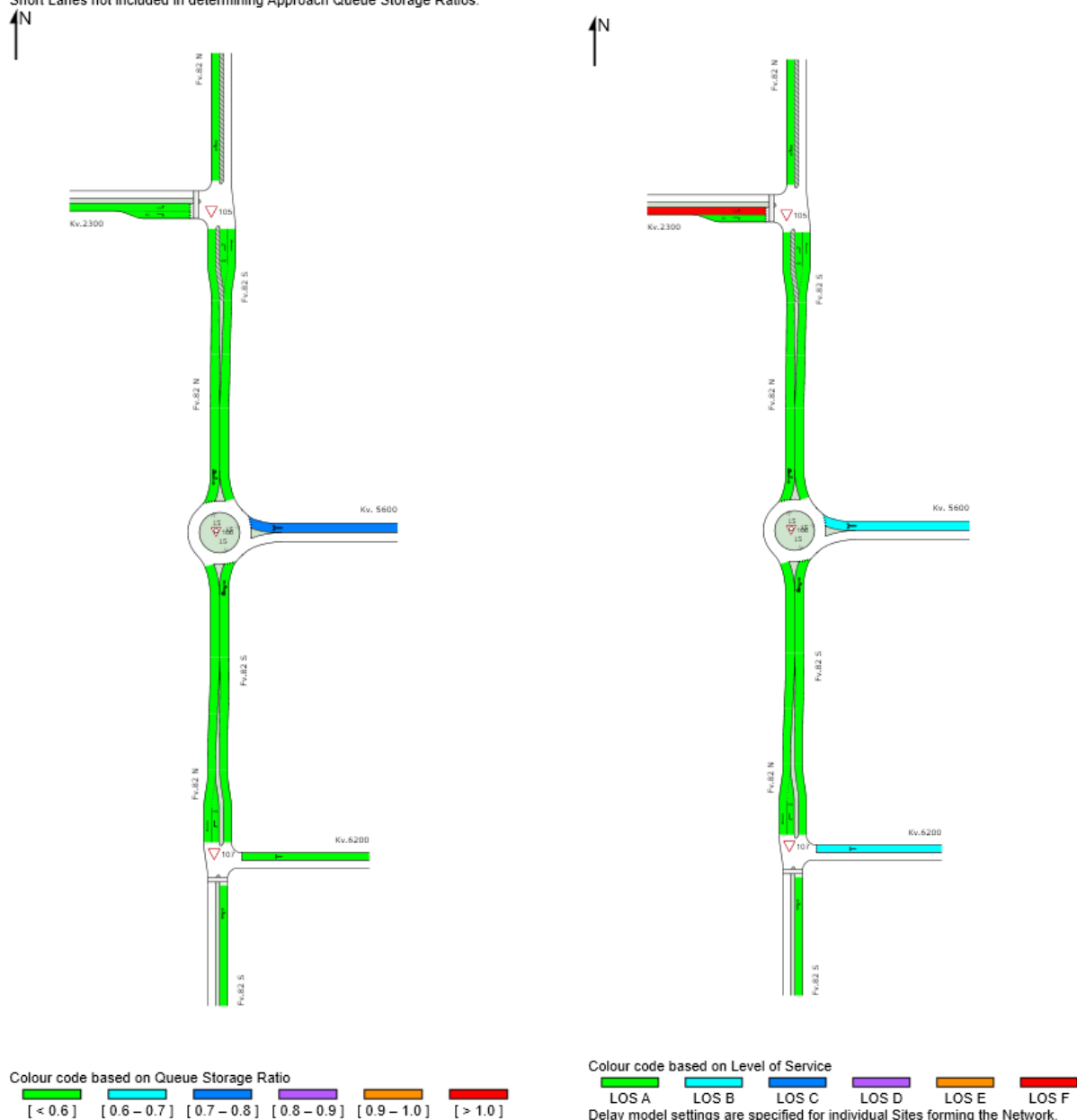
Figur 33 - Beregningsresultater for Nettverk 2, kryss 05 til 07. Henholdsvis «Queue Storage ratio» og «Level of service». Over ses også den grafiske fargekoden på forholdet mellom beregnet verdi og maksimal verdi, 100%.
